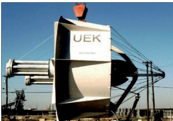
Fig. 1: Illustrations d'une turbine immergée de type Underwater Electric Kite (UEK) de 3m de diamètre (UEK Corp.).
