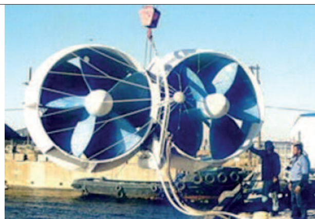
Fig. 1: Illustrations d'une turbine immergée de type Underwater Electric Kite (UEK) de 3m de diamètre (UEK Corp.).
